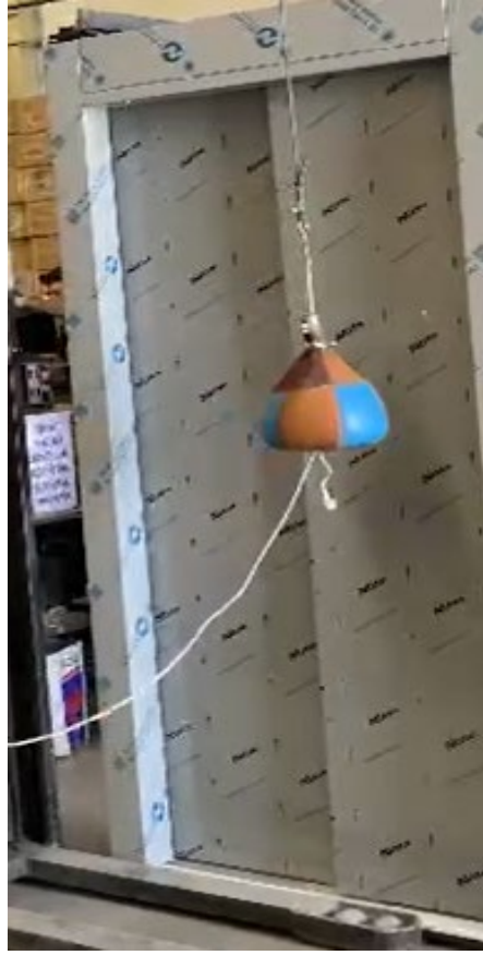
Resim 3: Yumuşak darbe deney cihazı
