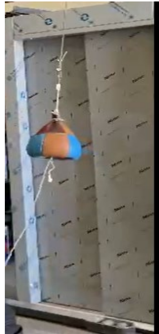
Resim 3: Yumuşak darbe deney cihazı
